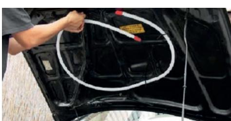
Automatický plynový hasicí systém slouží k ochraně prostoru motoru. Obsahuje plynové hasivo FM-200 (heptafluoropropan).
